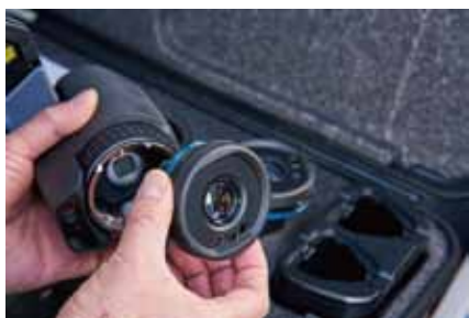
AutoCal™ 光学によりシリーズの全カメラでレンズ (広角から望遠) の共有が可能
